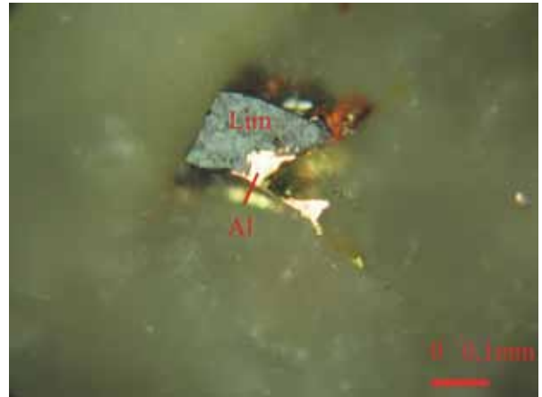
Şekil 18. Limonitleşmiş (Lim) pirit ve gang içinde altın (Al).
